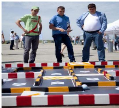
Sphero - это робот-шар, управляемый устройством на iOS или Android (телефон или планшет). Устройство соединяется с робощаром Sphero с помощью специального приложения. Шар управляется джойстиком на экране приложения: просто наклоняете мобильное устройство и шар катится в нужную сторону.
