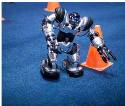
Robosapien имеет 67 программируемых функций, включающих в себя захват и бросание предметов, удары, сгибания, танец, а также набор движений каратэ.
